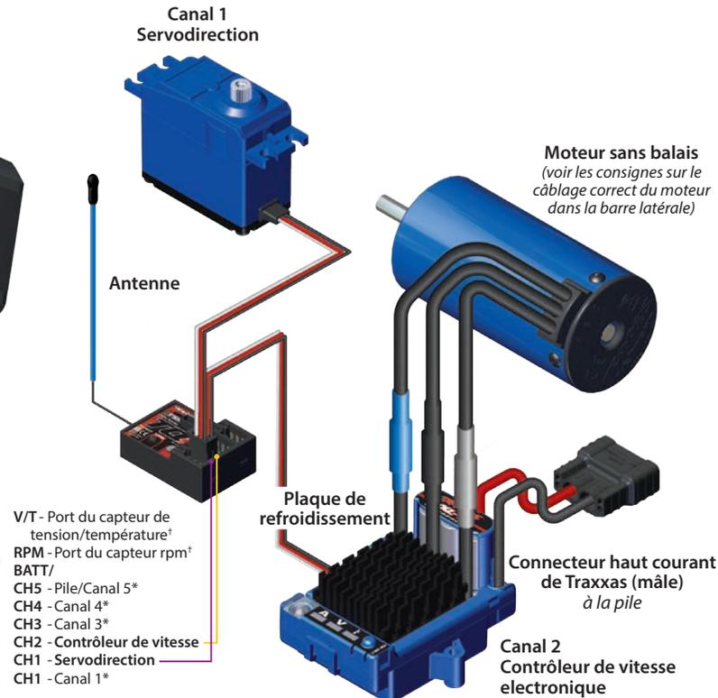
\*Non utilisé †Ports de capteur accessoire à utiliser avec les capteurs standard de télémétrie pour la tension/température et rpm (voir plus de renseignements sur Traxxas.com et dans les matériels fournis)
