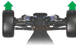
7. Actionnez doucement l'accélérateur pour vous assurer que le véhicule bouge en avant et en arrière et que le moteur s'arrête lorsque l'accélérateur est à la position neutre. Attention : N'accélérez pas à fond en avant ou en arrière tant que le modèle est élevé.
