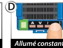
4. Le témoin DEL clignote et puis devient vert constant (le détecteur de basse tension est ACTIVÉ) ou rouge constant (le détecteur de basse tension est DÉACTIVÉ). Le modèle est prêt à conduire.
