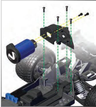
Pour régler l'engrènement, utilisez le diagramme à droite pour identifier les positions des vis sur le couvre-engrènement (A-I) qui correspondent à la dimension du pignon moteur (15T - 23T) et du pignon droit (47T) choisis. Retirez les deux vis du moteur/couvre-engrènement et réinstallez-les dans les positions correspondantes, puis réinstallez l'ensemble moteur/couvre-engrènement sur le châssis.
