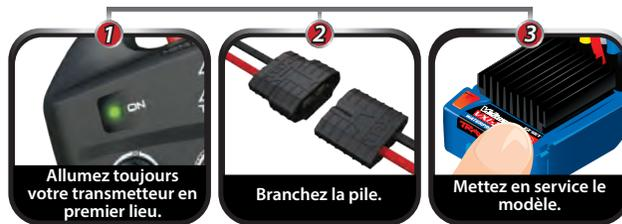
• Utilisez toujours des piles nouvelles pour le système radio. Les piles faibles limitent le signal radio entre le récepteur et le transmetteur. La perte du signal radio peut faire perdre contrôle du modèle.
