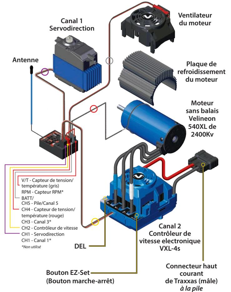
\*\* Port de capteur accessoire à utiliser avec le module d'extension de télémétrie (voir plus de renseignements sur Traxxas.com et dans les matériels fournis).
