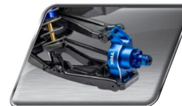
Porte-moyeu de roue arrière en aluminium
