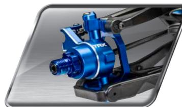
Moyeux-C et blocages de la direction en aluminium
