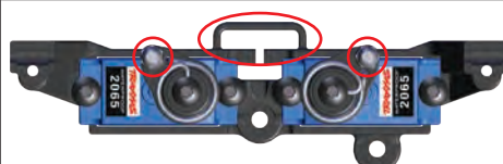
Support de servo T-Lock du châssis
